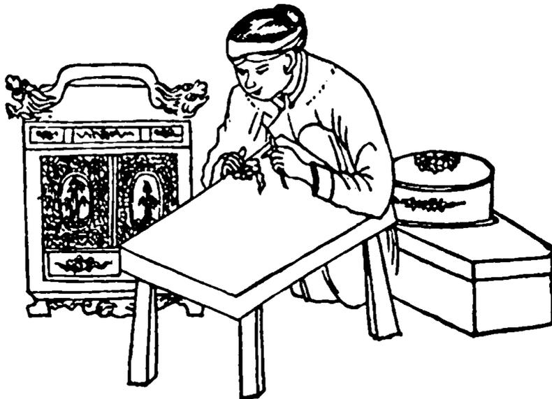
FIG. 6.- L'INCRUSTEUR TRAVAILLE LA LAMELLE DE NACRE
